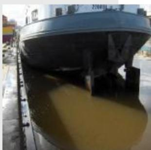
KLP® Fender verschleifen nicht und hinterlassen keine schwarzen Streifen auf dem Schiffsrumpf. Das elastische Material federt leicht, wodurch die Stossenergie absorbiert wird.
